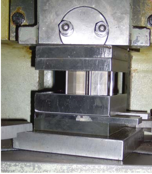
Resim4.1: Kesme ve delme işlemini aynı anda yapabilen bileşik kalıp
