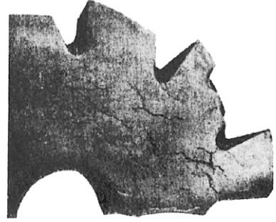
Verilen sertleştirme sıcaklığının üst sınırının üzerinde sertleştirilmiştir.
