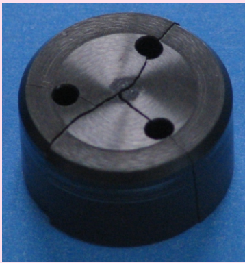
Şekil 13. Takozda Görülen Kırılma
